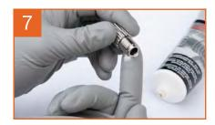
Graisser\* le filetage de la vis de réglage Monter la vis de réglage de flux produit de flux produit
