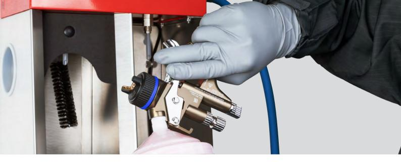
Le SATA clean RCS est un système de nettoyage à air comprimé pour le nettoyage intermédiaire de pistolets de peinture. Le SATA clean RCS – the turbo cleaner dans la cabine de peinture permet plusieurs changements de couleur successifs avec des interruptions de nettoyage extrêmement courtes. Cela permet non seulement d'économiser des trajets de travail supplémentaires et du temps, mais aussi d'augmenter la productivité et la rentabilité.
