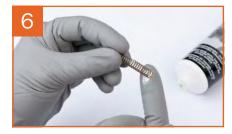
Graisser\* et insérer le ressort de l'aiguille de peinture
