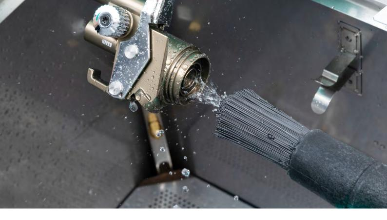
Les pistolets de peinture doivent être nettoyés soigneusement au minimum une fois par jour et rincés après chaque opération de peinture. Le travail s'effectue de façon délicate, confortable et rentable avec le SATA multi clean 2 – l'automate de lavage performant avec aire de lavage manuel et dispositif d'aspiration.
