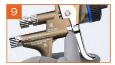
Graisser la partie visible de la tige du piston d'air
