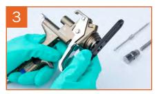
Dévisser la buse de peinture à l'aide de la clé polygonale intégrée dans l'outil universel.
