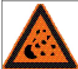
**Metalo atplaišos:** magnetai sutrūkinėja ir dėl netikėto smūgio jie gali sulūžti bei gali pasklisti atplaišos. Aštriau nėštumės atplaišos gali skrieti kelis metrus ir pažeisti akis. Stenkite išvengti nekontroliuojamų smūgių į magnetus. Dirbdami su didesniais magnetais užsidėkite apsauginius akinius ir atkreipkite dėmesį, kad aplink esantys asmenys taip pat būtų apsaugoti arba laikytu siame.
