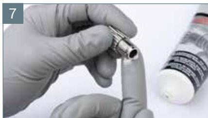
Gewinde der Materialmengenregulierschraube einfetten
