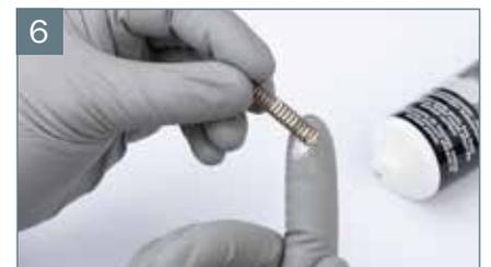
Farbnadelfeder einfetten und einsetzen
