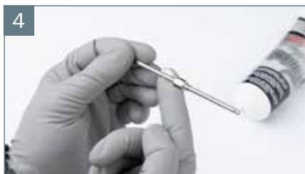
Farbnadel im Bereich der Nadeldichtung einfetten
