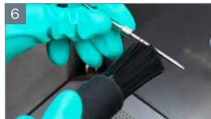
Durante la limpieza de elementos del juego de boquilla se tiene que prestar atención a que la parte de metal de los cepillos no dañe el juego de boquillas. En el caso ideal se utilizan pinceles, cepillos de limpieza SATA y agujas de limpieza de boquilla SATA particularmente fabricados para asegurar un mantenimiento y una limpieza óptimos del juego de boquillas.
