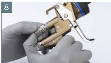
Montar el tornillo de regulación de material
